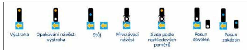
Návěstidla pro výhradní provoz ETCS se značkami STOP.
