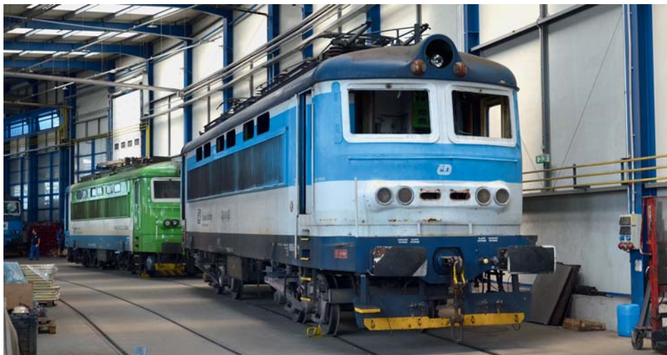
Vyvázaná lokomotiva 242.221 připravená na tryskání a lak
