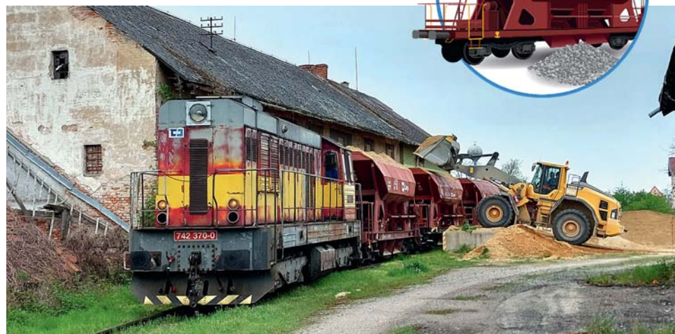
Lokomotiva 742.370 posunuje 24. dubna 2023 s vozy v Hodonicích, kde se nakládá písek z nedaleké pískovny Tasovice. Nakládka 5 vozů Faccs za pomoci kolového nakladače a zvýšené rampy trvá přibližně 50 minut. FOTO: MARTIN ŠEVČÍK
