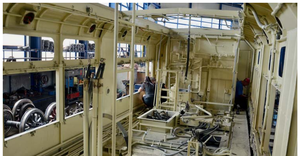
„Plecháč“ 242.212 po laku, ve fázi montáže. Na konci srpna by měl být předán ČD Cargo.
