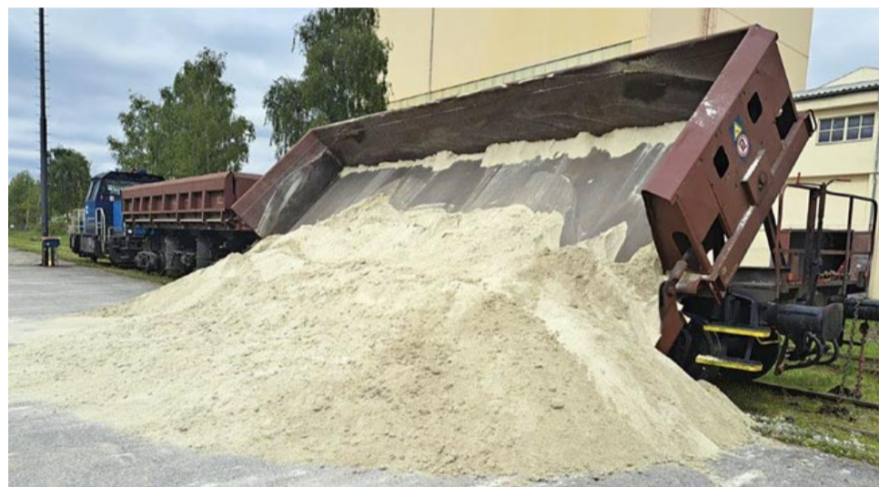
Vykládka živce z vozu Dumpcar na vlečce v Borovanech FOTO: VÁCLAV PLEČER
