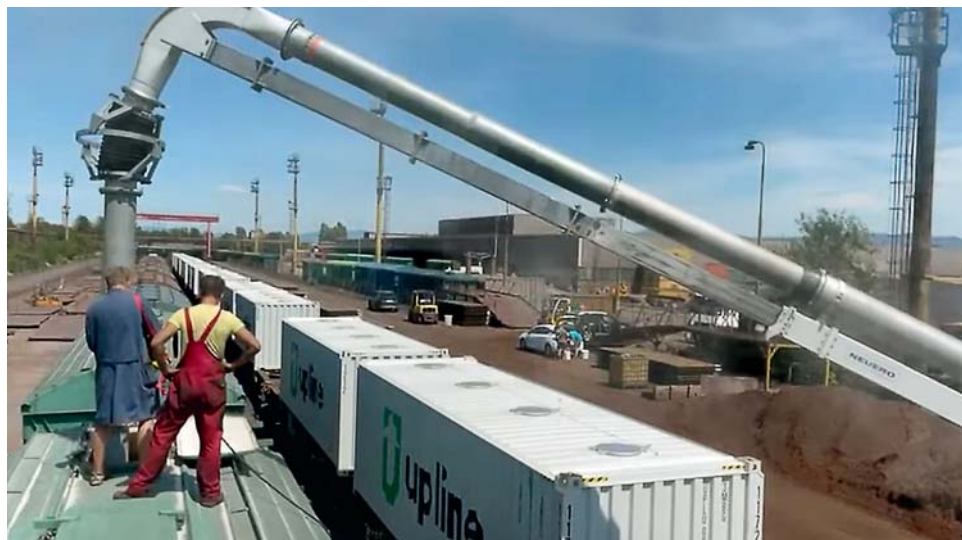
Překládka obilí ze širokorozchodných vozů do kontejnerů v terminálu Interport
