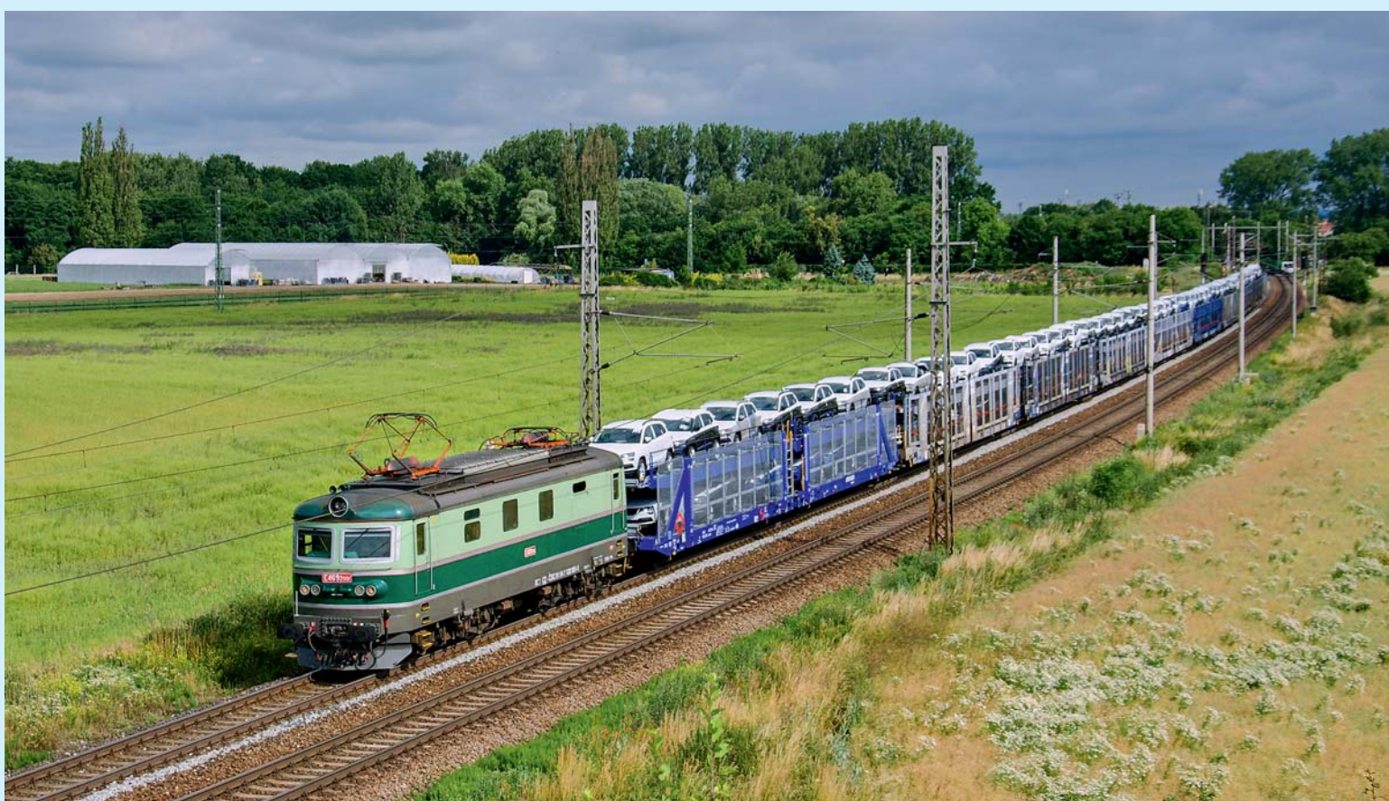
„Staročeska“ 122.001 (E 469.2001) na první pohled zaujme zářivě oranžovými sběrači a spojovacími tyčemi elektrovýzbroje na střeše. 1. července 2021 se s vlakem z Nymburka do Týniště nad Orlicí blíží do stanice Velký Osek.
