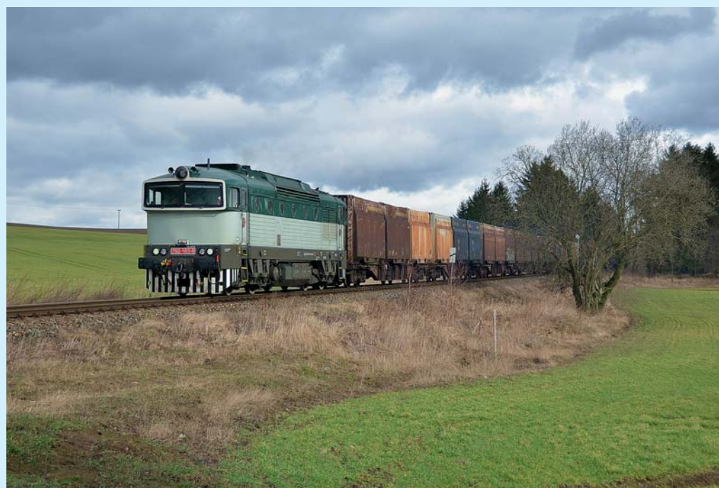
V rámci opravy ve Zvolenu byl stroj s číslem 750.163 opatřen zeleno-šedým retro nátěrem. V případě této lokomotivy se nejedná o návrat do původní barevné kombinace, lokomotiva totiž opustila brány výrobního závodu v červeném kabátě, který později vyměnila za „korporát“ ČD Cargo. Retro nátěr má za cíl připomenout tradici výroby těchto lokomotiv v ČKD Praha. V mezistaničním úseku Žďrec nad Doubravou – Chotěboř byla lokomotiva vyfotografována 26. února 2020. Foto: Lukáš Růžička
