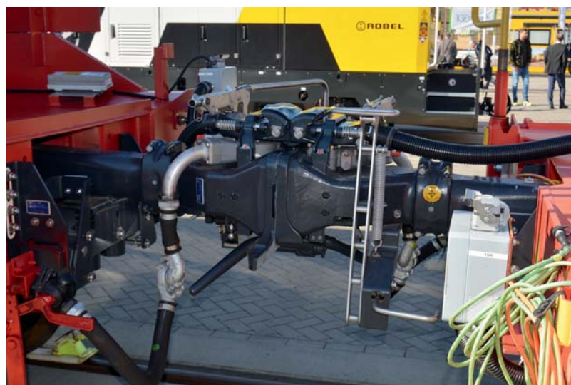
Spráha DAC firmy Voith vyšší verze, vystrojené i konektorem pro vedení elektrického proudu mezi vozy
