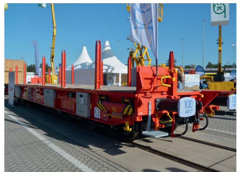
Šestinápravový plošinový vůz z produkce Tatravagonky Poprad řady Sagmms určený pro DB Cargo. Vůz je již připraven pro vystrojení digitálním automatickým spráhem.
