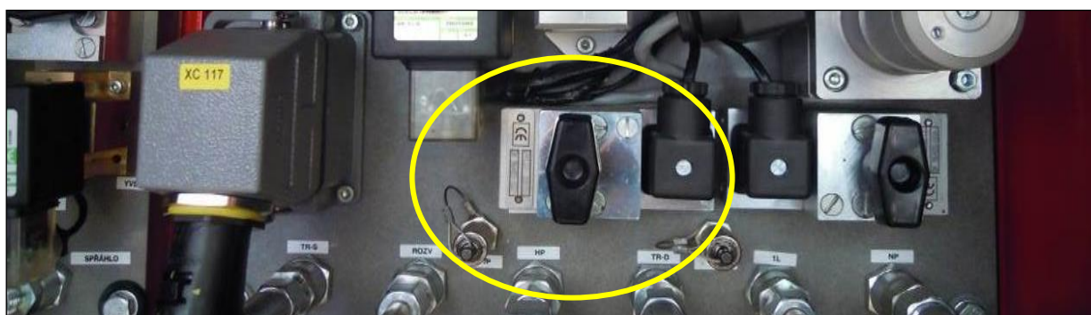
obr. 2: Uzavírací kohout součinnostního ventilu – panel doplňkové brzdy
